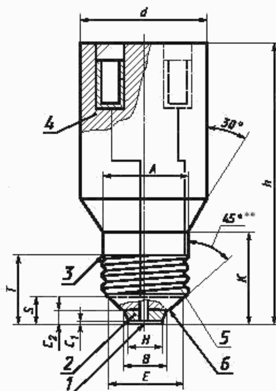
1 — стальная пластина; 2 — изоляционный материал\*; 3 — скругление\*\*\*; 4 — металл; 5 — латунный цоколь;
