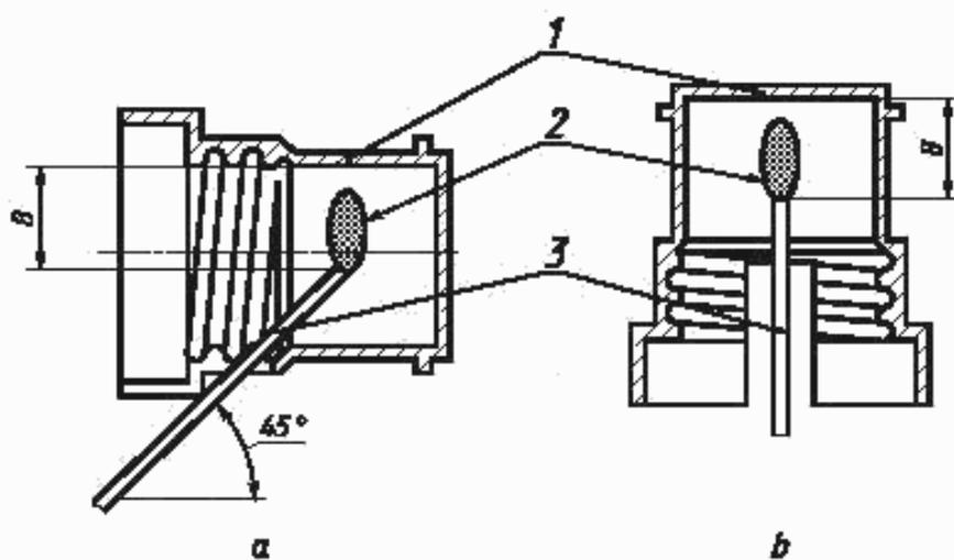
Рисунок *a* показывает, как проводить испытание игольчатым пламенем боковой контактной поверхности (не применимо к патронам E40).
