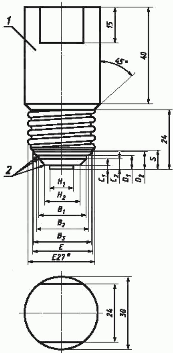
1 — твердая сталь; 2 — острые кромки притупить
