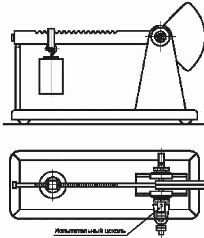
Рисунок 6 — Установка для проверки на скручивание
