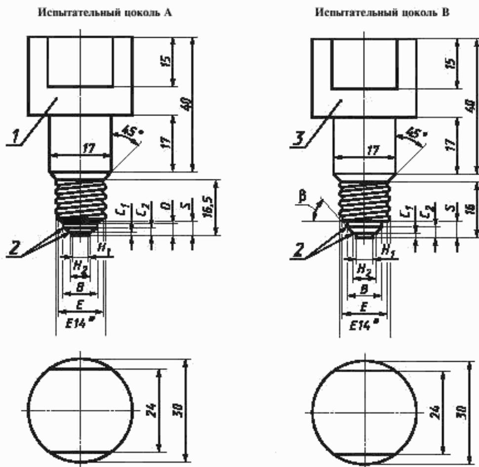
1 — твердая латунь; 2 — острые кромки притупить; 3 — твердая сталь
