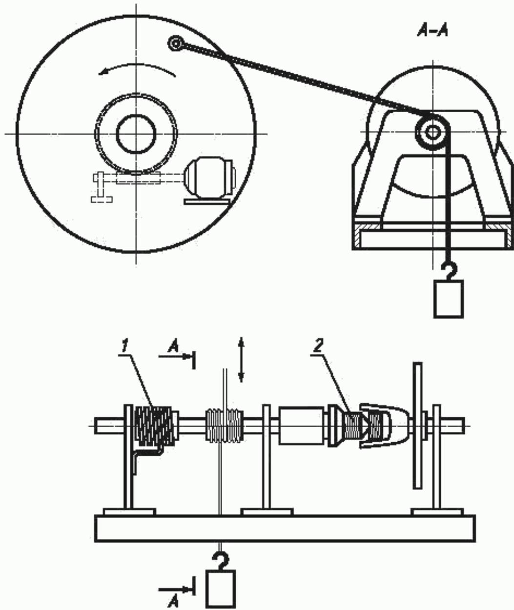
1 — направляющее устройство; 2 — испытательный покол.
