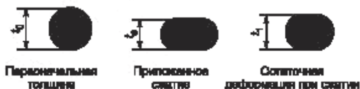
Рисунок 6 — Остаточная деформация при сжатии уплотнительного кольца
