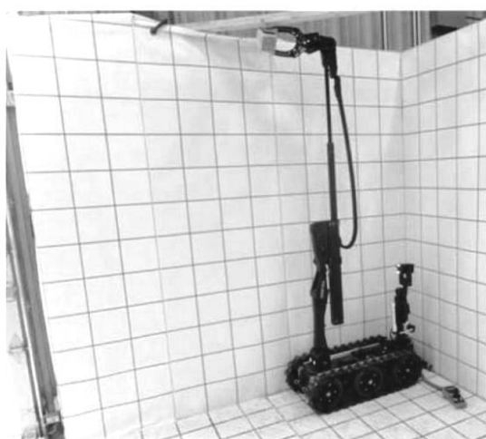
Рисунок 1 — Пример стенда, на котором робот может быть сфотографирован для документирования его конфигурации
