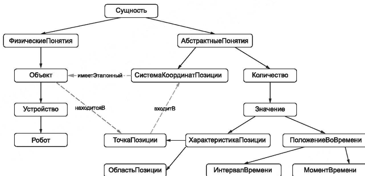
Рисунок 6 — Таксономия основных концептуальных понятий онтологии POS, соответствующих действиям робота в физической среде
