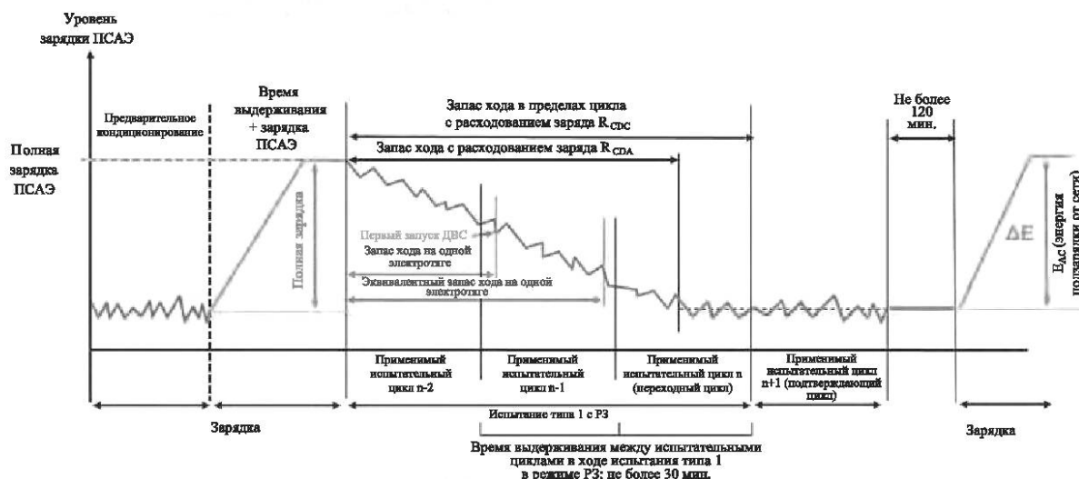
Рисунок Е.7 — ГЭМ-ВЗУ и ГТСТЭ-ВЗУ, испытание типа 1 в режиме расходования заряда
