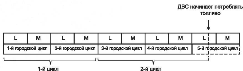
Рисунок Д.2 — Пример четного количества завершенных городских испытательных циклов, предшествующих городскому циклу, в ходе которого ДВС начинает потреблять топливо
