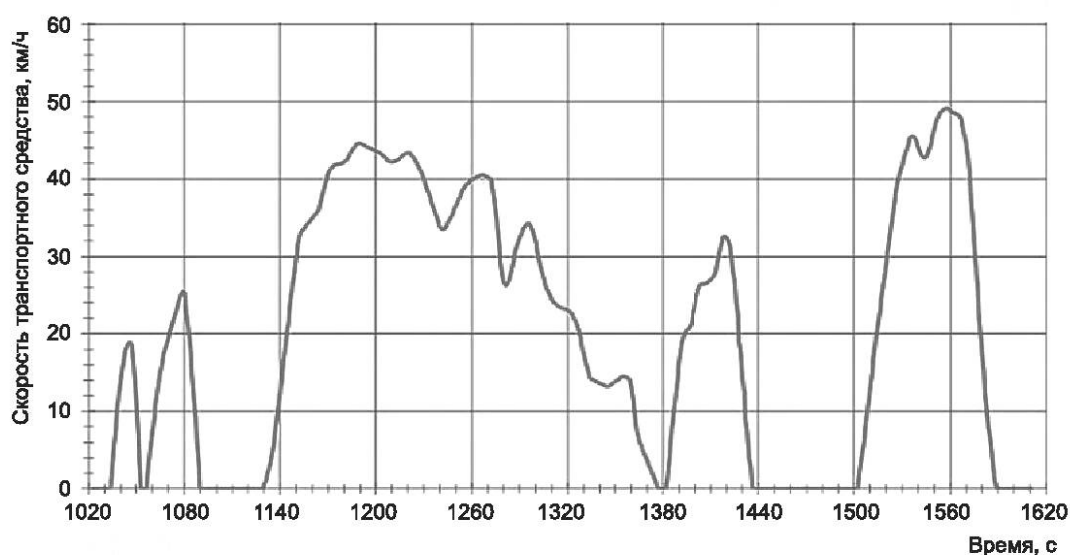
Рисунок А.2б — ВЦИМГ, цикл применительно к классу 1, фаза Low 1,2
