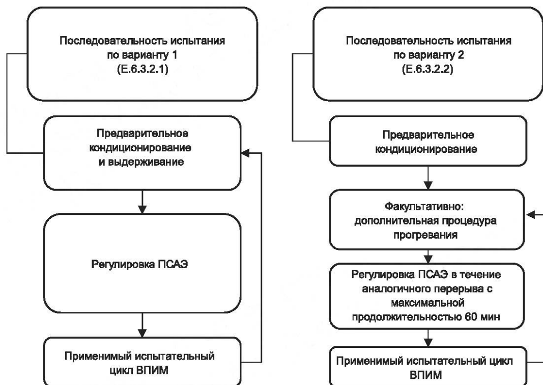
Рисунок Е.15 — Последовательности испытания ГЭМ-БЗУ и ГТСТЭ-БЗУ
