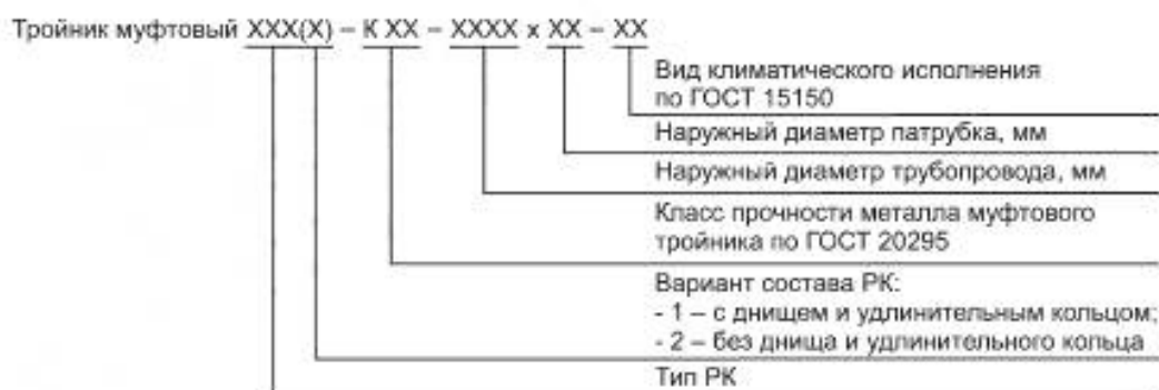
Рисунок 3 — Схема условного обозначения муфтового тройника
