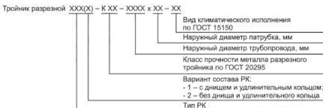
Рисунок 4 — Схема условного обозначения разрезного тройника
