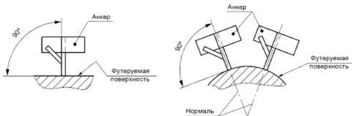
Рисунок 11 — Расположение S-образных анкеров на футеруемой поверхности
