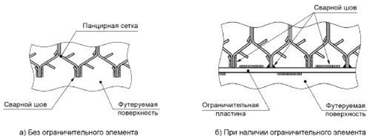
Рисунок 9 — Варианты приварки свободных концов панцирной сетки
