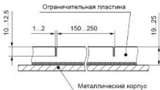
Рисунок 4 — Пазы в ограничительной пластине однослойной футеровки
