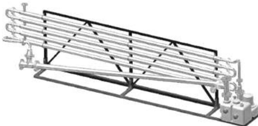
Рисунок 5 — Общий вид варианта моноблочной компоновки теплообменника-утилизатора сточных вод с побудителем циркуляции и выпуском-байпасом
