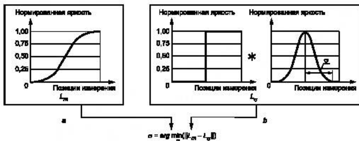
Рисунок 4 — Схематическое изображение, иллюстрирующее метод расчета стандартного отклонения с применением модели размытия по Гауссу
