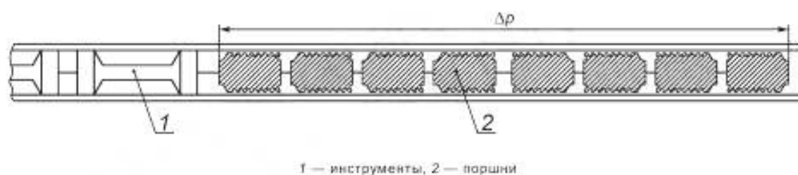
Рисунок 1 — Дифференциальное давление \Delta p
