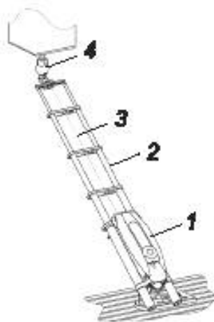
1 — интерферометр; 2 — телескоп; 3 — измерительный луч; 4 — сфера с отражателем
