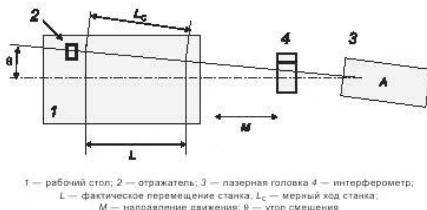
Рисунок 2 — Косинусная погрешность при измерении лазерным интерферометром
