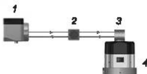
1 — лазерная головка; 2 — угловой интерферометр; 3 — угловой отражатель; 4 — устройство индексации угла
