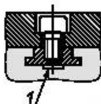
Рисунок D.6 — Правильное расположение гаек и болтов
