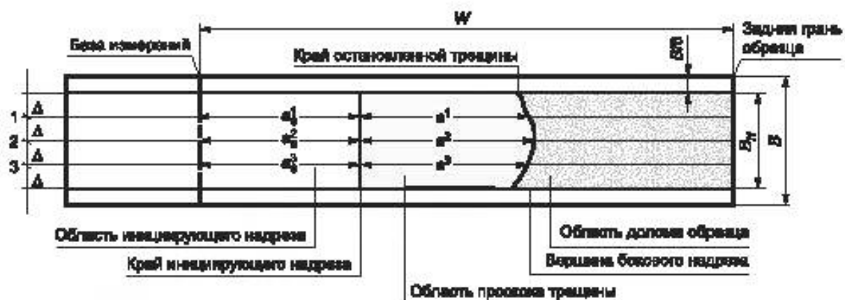
Рисунок Ж.2 — Схема определения длины иницирующего надреза и длины остановленной трещины для образцов типа CCA и DCA
