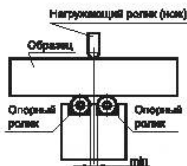
Рисунок 8.1 — Схема нагружения плоского прямоугольного образца без краевой трещины [калибровочного образца типа SE(B)] при испытаниях на трехточечный изгиб
