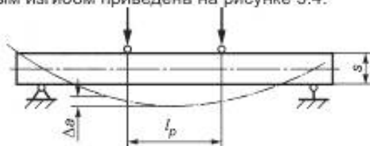
Рисунок 5.4 — Схема нагружения призматического образца чистым изгибом
