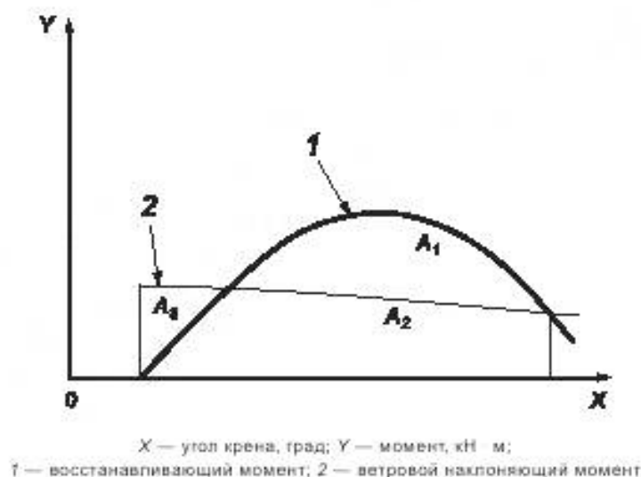
Рисунок 3 — Требования остойчивости в поврежденном состоянии
