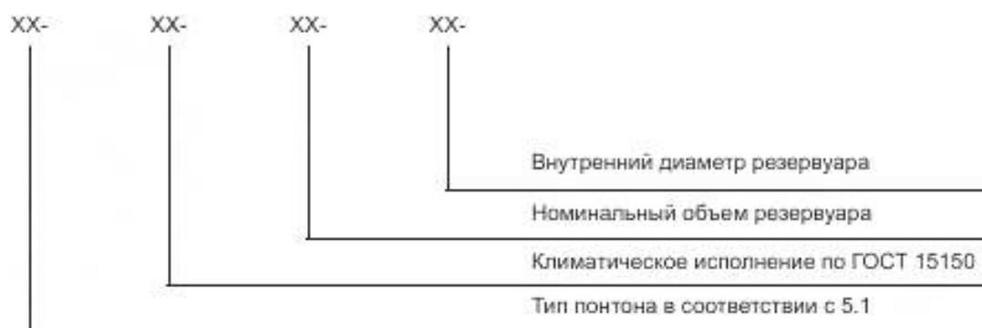
Рисунок 1 — Схема условного обозначения понтона
