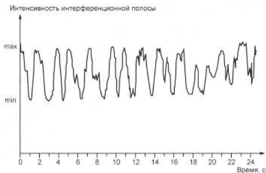
Рисунок 12 — Полосы интерферометра Майкельсона, медное зеркало
