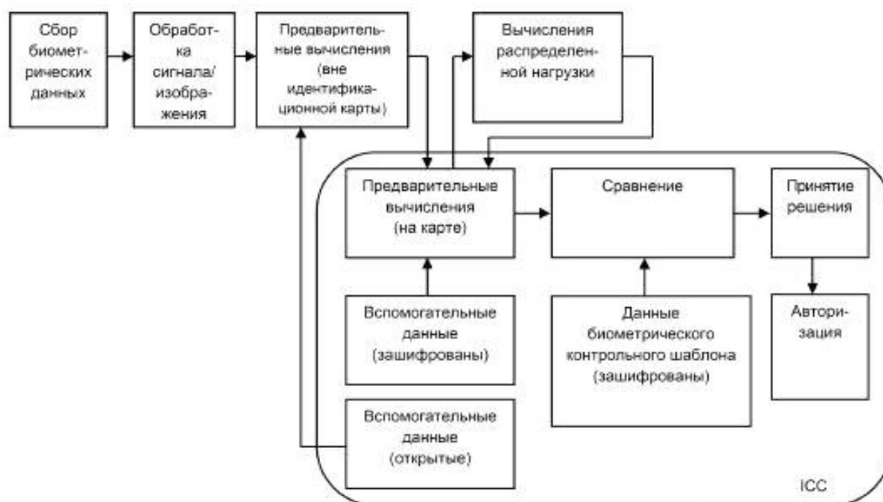
Рисунок 3 — Общая архитектура для биометрического распознавания с распределением нагрузки
