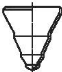
Рисунок 15 — Эскиз наконечника из трех переходов и заглушки
