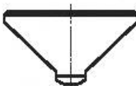
Рисунок 16 — Эскиз наконечника из перехода и заглушки
