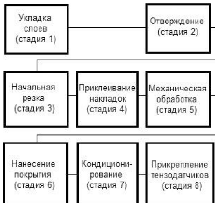
Рисунок 1 — Процесс изготовления образцов для испытания
