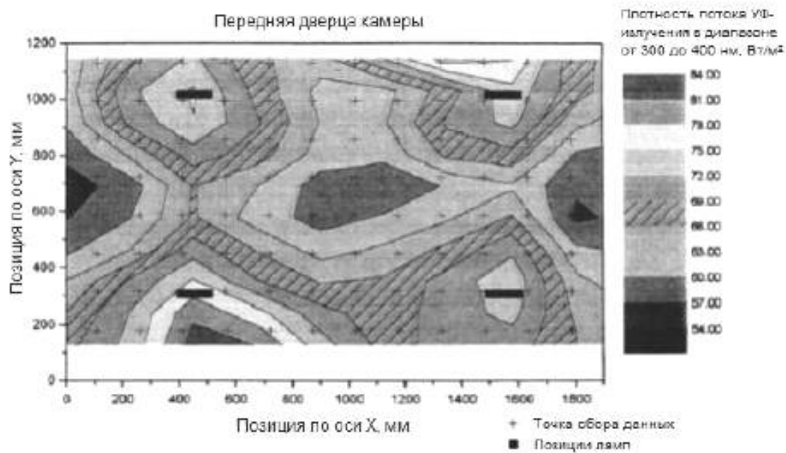
Рисунок X1.3 Пространственное распределение УФ-излучения внутри камеры для выдерживания образцов типа XR-260
