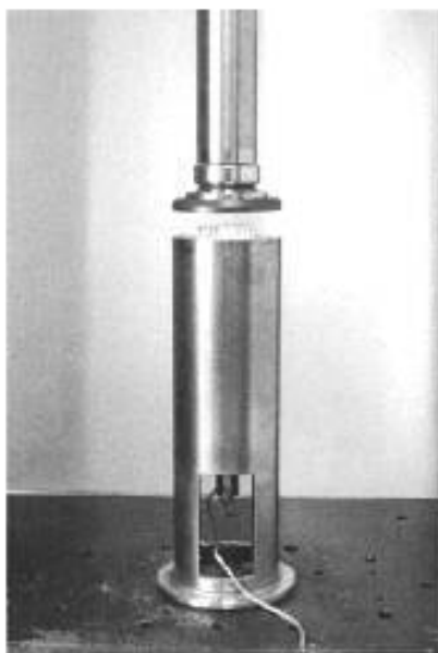
Рисунок 1 — Плита пресса с датчиком и регулировкой стержня
