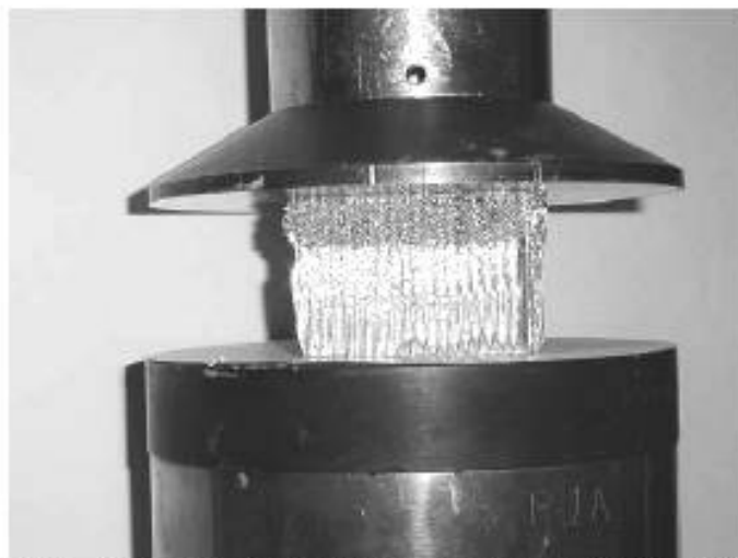
Рисунок 2 — Сведение нагрузочных плит вокруг сжимаемого образца
