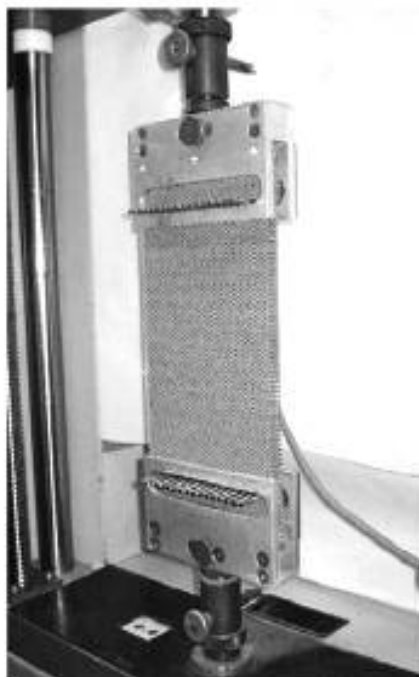
Рисунок 1 — Машина для испытания для определения предела прочности на растяжение в узлах сотового материала внутреннего слоя «сэндвич»-конструкций
