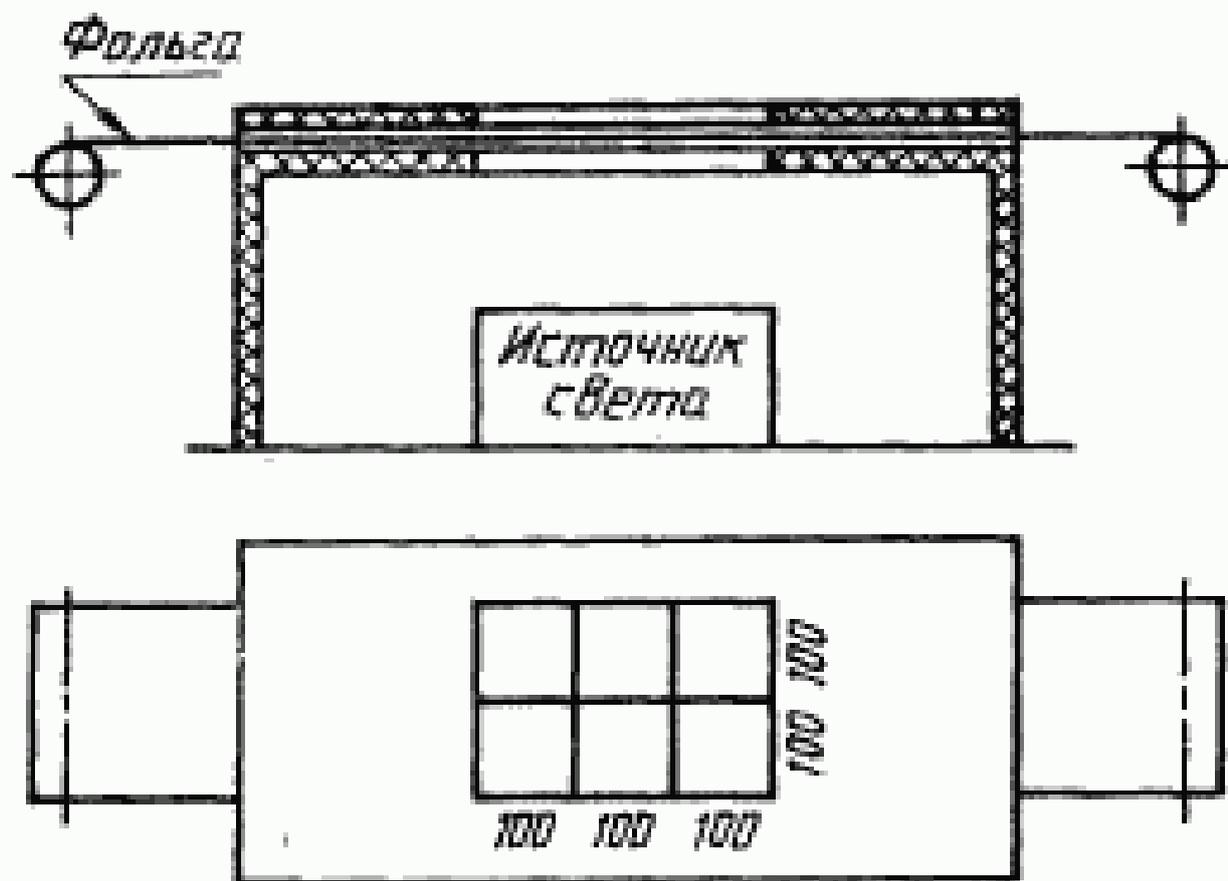
Прибор изготавливается в форме ящика, внутри которого пред достаточно освещение. В верхней части ящика вырезают отверстиной формы, в котором устанавливают сетку с клетками площадью 1
