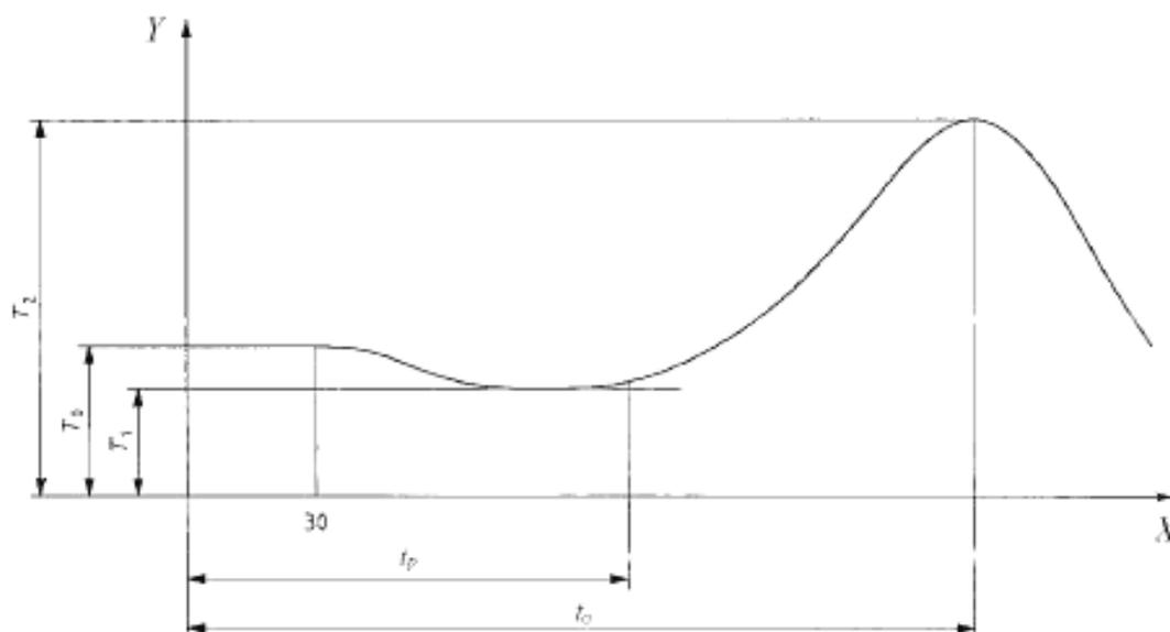
$X$  – время, с;  $Y$  – температура,  $^\circ\text{C}$ ;  $T_0$  – температура во время закладки образца;  $T_1$  – температура после небольшого снижения сразу после закладки материала;  $T_2$  – максимальная температура;  $t_p$  – время от начала смешивания до начала реакции отверждения при  $T_1$ , обозначенное как рабочее время;  $t_0$  – время от начала смешивания до времени достижения максимальной температуры, обозначенное как время отверждения
