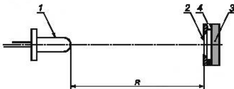
1 — СД; 2 — круглое входное отверстие; 3 — фотометрическая головка; 4 — светофильтр
