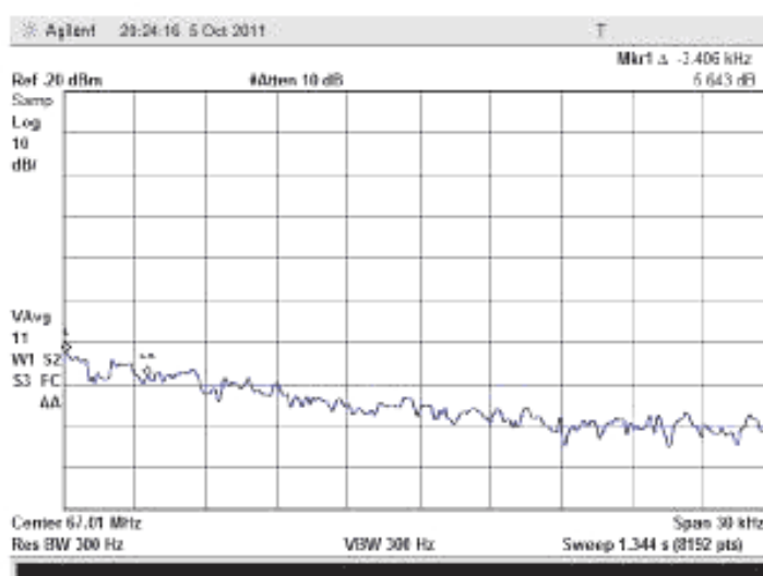
Рисунок В.19 – Форма спектра на частоте f_{(0+150)} в полосе сканирования 30 кГц
