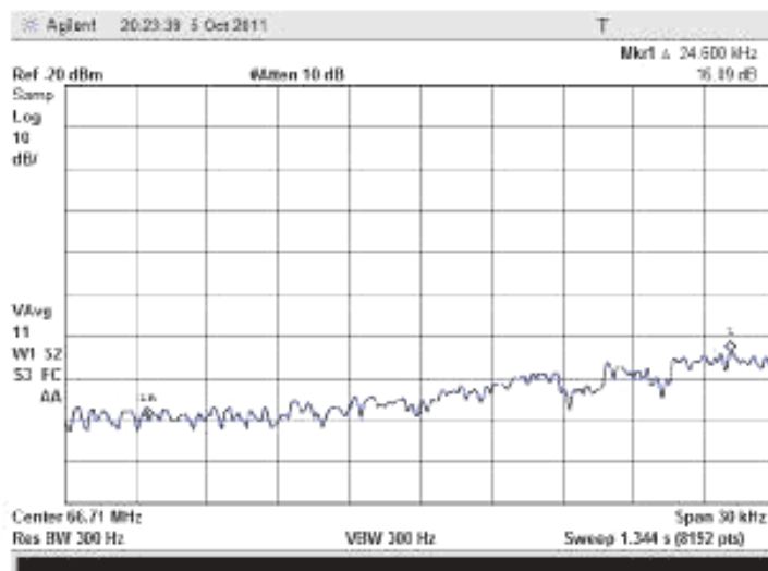
Рисунок В.20 – Форма спектра на частоте f_{(10-150)} в полосе сканирования 30 кГц
