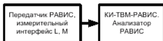
Рисунок 7 – Схема измерения искажений сигналов I и Q
