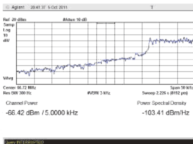
Рисунок В.26 – Плотность мощности минус 103,4 дБм/Гц на частоте f_{(10-135)}
