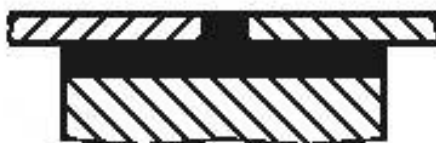
Рисунок А.9 — Пищевая зона. Непрерывный шов с плоской лицевой поверхностью и накладкой
