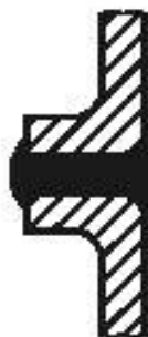
Рисунок А.13 — Зона разбрызгивания. Крепеж, который нельзя удалить
