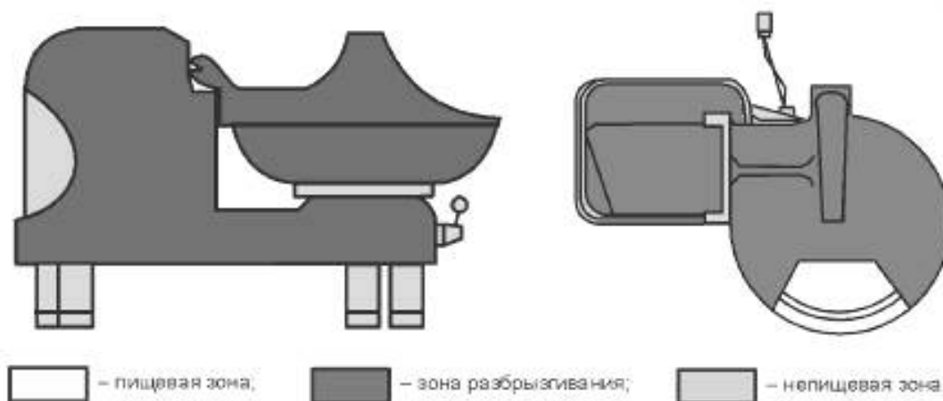
Рисунок 9 – Гигиенические зоны куттера типа 1
