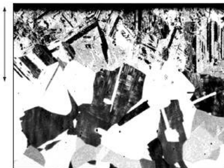
Рисунок 10 — Пример образования эпсилон-мартенсита в обезуглероженной поверхностной зоне закаленной аустенитной марганцовистой стали, содержащей менее 0,5\% углерода ( 100\times , травление 2 %-ным спиртовым раствором азотной кислоты в течение 5 с, а затем 20 %-ным водным раствором пиросульфата натрия в течение 20 с)
