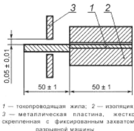
Рисунок 18 — Схема устройства для испытания на адгезию
