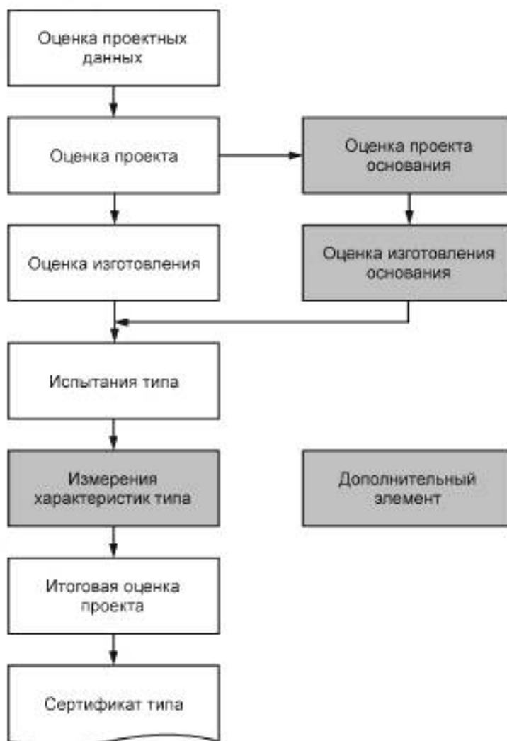
Рисунок 1 — Блок-схема процедуры сертификации типа
