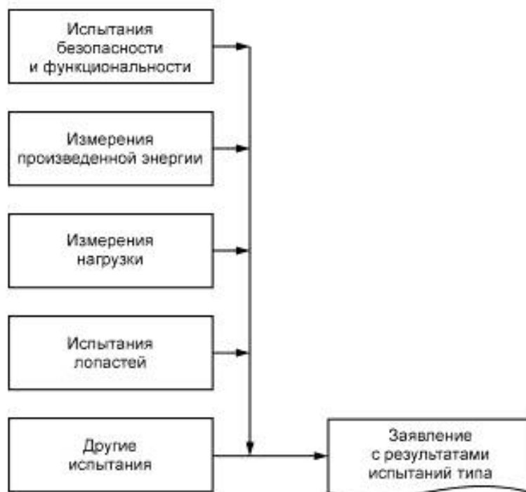
Рисунок 5 — Блок-схема процедуры типовых испытаний
