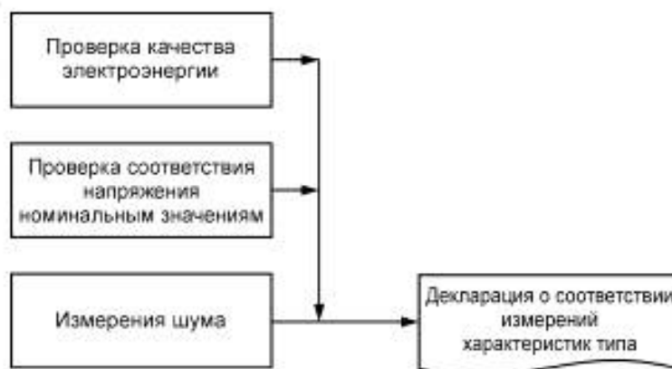
Рисунок 6 — Блок-схема элементов измерения характеристик типа
