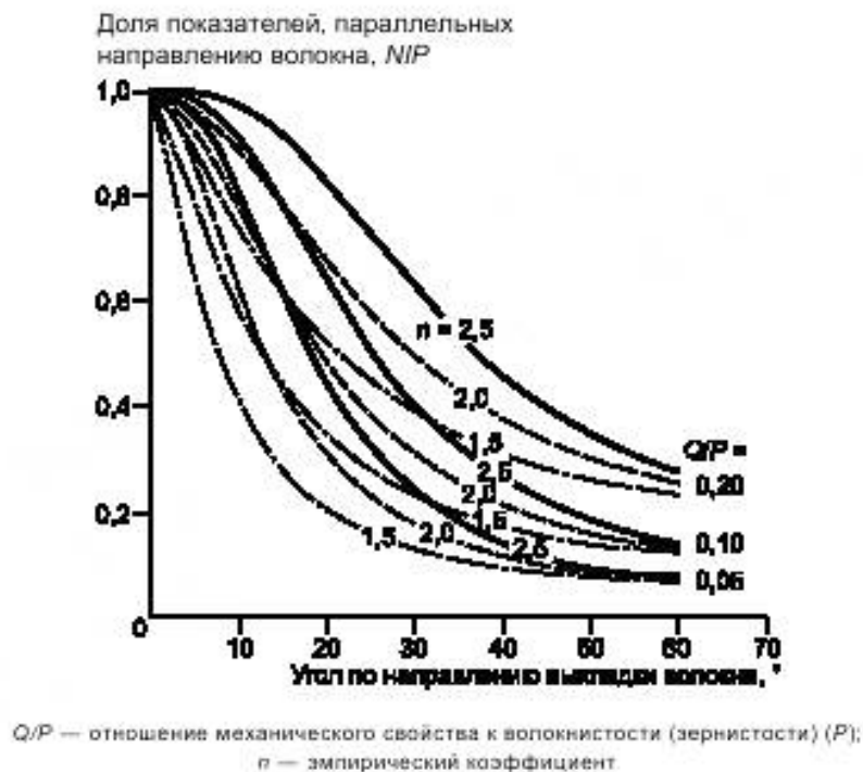
Рисунок Д.10 — Влияние угла зерна на механические свойства чистой древесины согласно формуле Хэнкинсона
