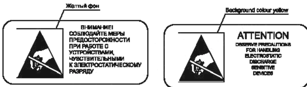
Рисунок 13 — Пример маркировки чувствительных к электростатическому разряду устройств
