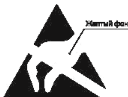
Рисунок 12 — Чувствительная к электростатическому разряду деталь или узел
