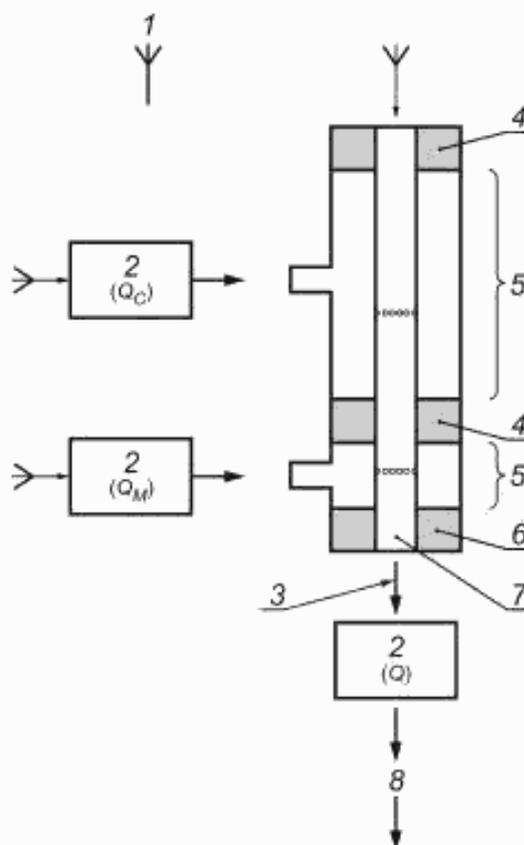
1 — атмосфера в соответствии с ГОСТ Р ИСО 3402; 2 — прибор для измерения объемного потока; 3 — перепад давления ( $\Delta P_z$ ); 4 — разделительные уплотнения; 5 — вентиляционная камера; 6 — фиксированное удерживающее уплотнение; 7 — выходной конец калибра вентиляции; 8 — общий поток пропускаемого воздуха
