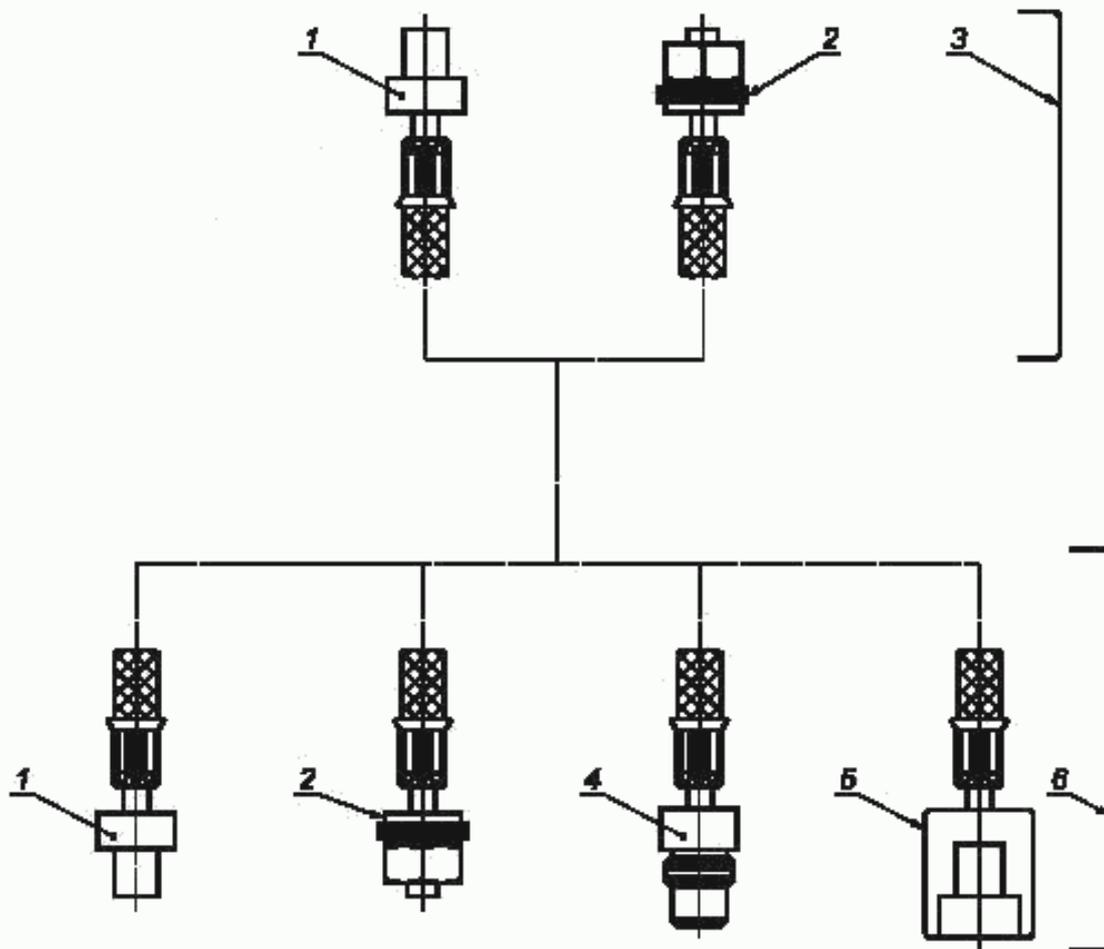
1 — наконечник; 2 — ниппель с гайкой NIST или DISS; 3 — входные соединители; 4 — корпус NIST или DISS; 5 — терминал или специфическое для газа соединительное отверстие; 6 — выходные соединители
