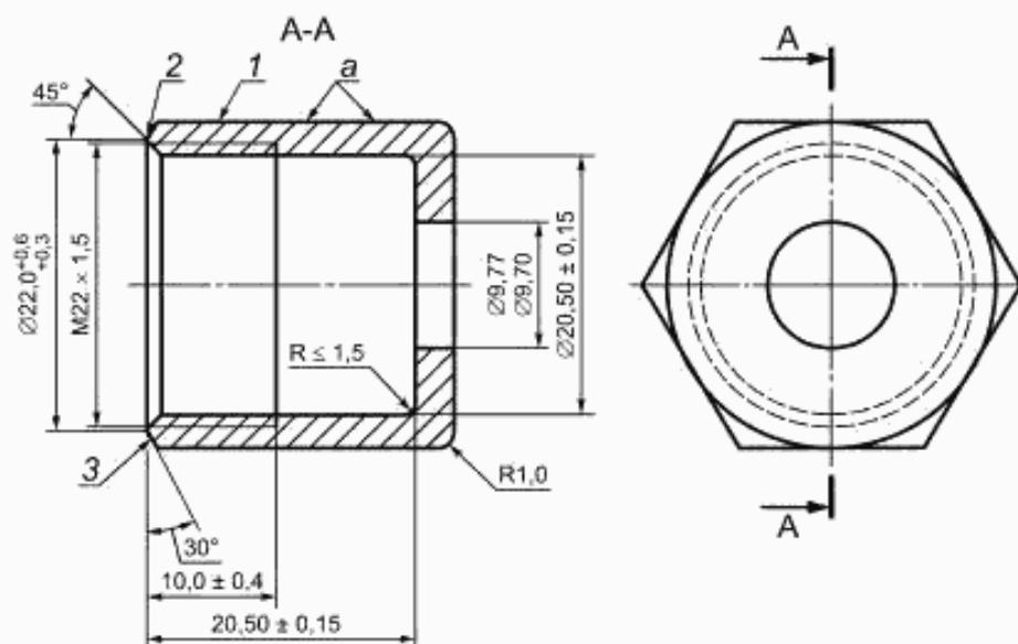
1 — только для идентификации гаек с левой резьбой применяется паз V-образного сечения на ребрах шестигранника на глубину до плоскостей граней; 2 — фаска до основания резьбы; 3 — внешняя фаска
