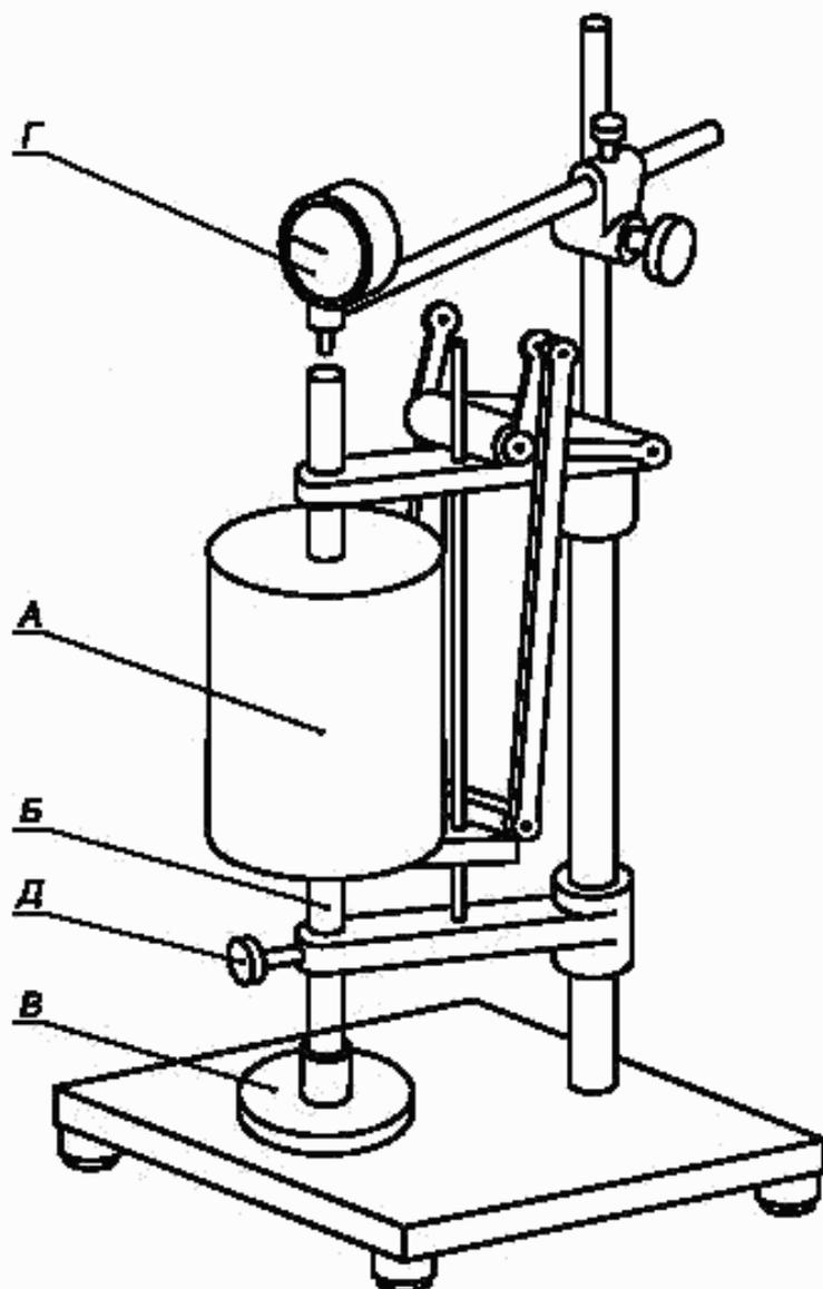
Рисунок 2 — Прибор для испытаний на текучесть
