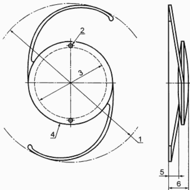
1 — общий диаметр; 2 — позиционное отверстие; 3 — оптическая часть; 4 — тело; 5 — высота свода; 6 — сактитель
