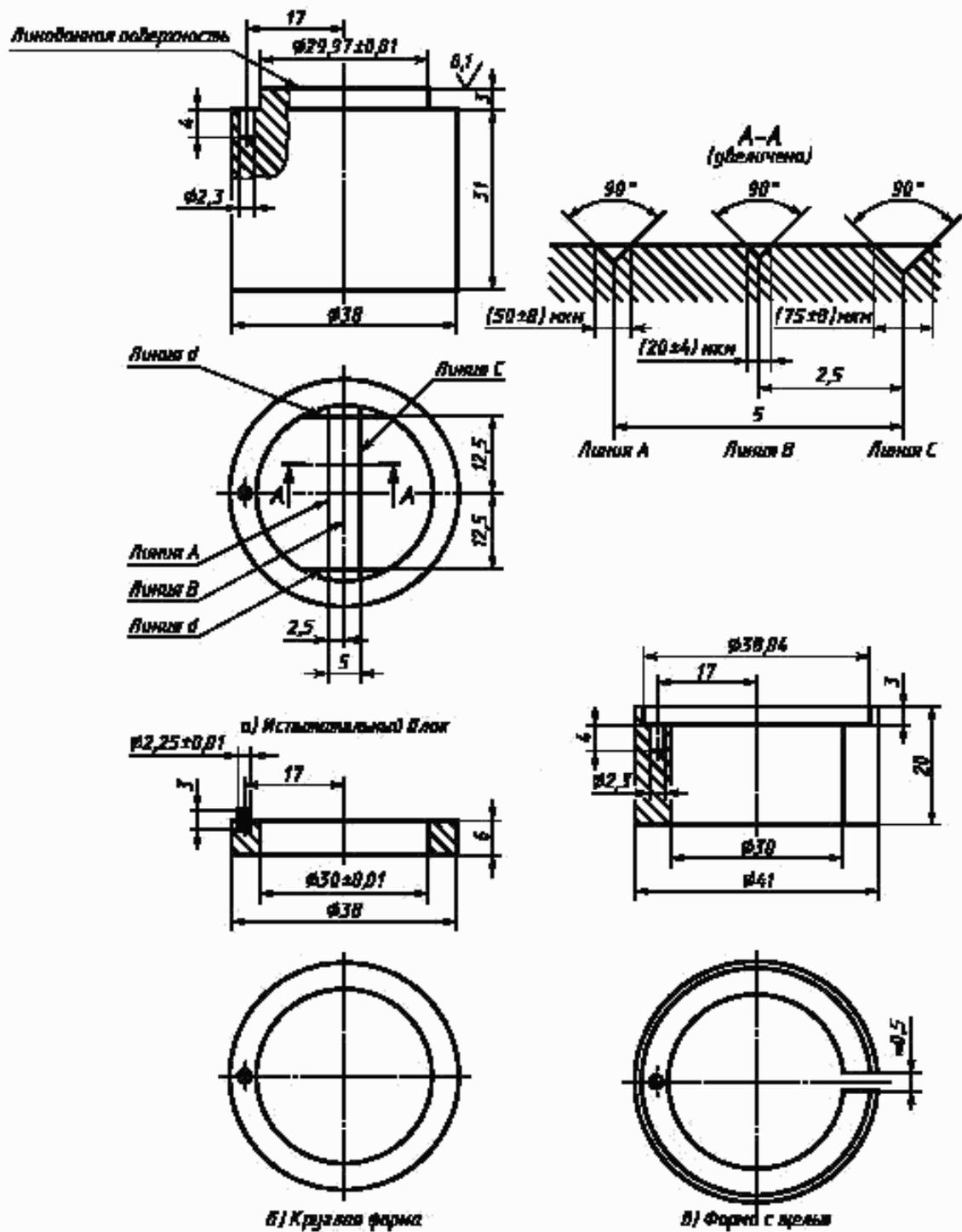
Рисунок 1 — Схема прибора для воспроизведения деталей
