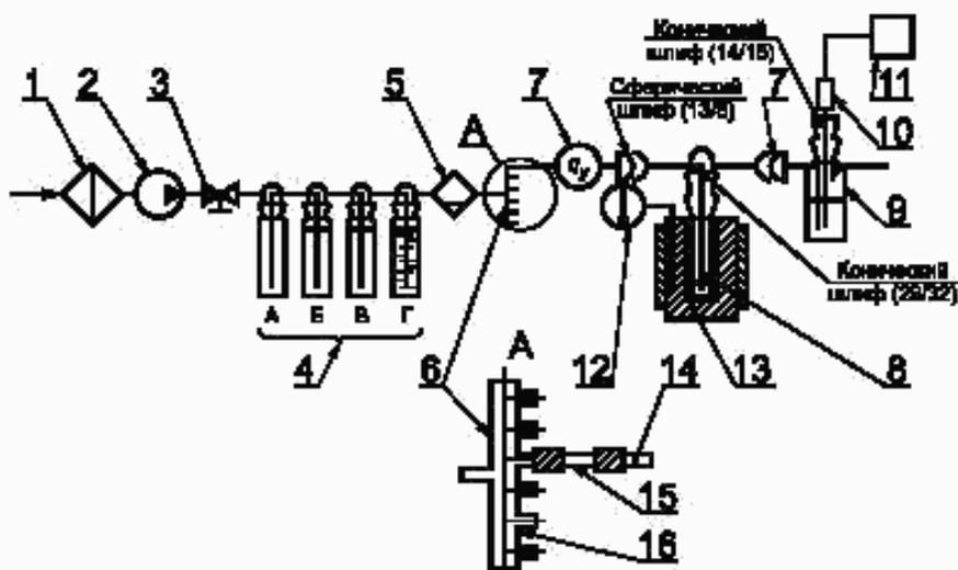
1 — воздушный фильтр; 2 — газовый диафрагменный насос; 3 — игольчатый клапан; 4 — промывные склянки А, Б, В, Г; 5 — капиллярная трубка; 6 — циркулятор воздуха; 7 — измеритель скорости потока воздуха; 8 — азрационный сосуд; 9 — измерительная ячейка; 10 — электрод; 11 — измерительное и записывающее устройство; 12 — тиристор и контактный термометр; 13 — нагревательный блок; 14 — ввод измерителя скорости потока воздуха; 15 — капиллярная трубка; 16 — циркулятор воздуха
