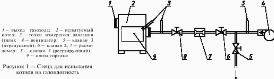
Рисунок 1 — Стенд для испытания котлов на газоплотность
