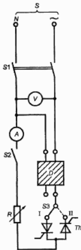
*S* — источник электрической энергии; *V* — вольтметр; *A* — амперметр, показывающий среднее квадратическое значение; *D* — испытуемое УЗО-ДП; *R* — регулируемый резистор; *Th* — тиристор; *S1* — двухполюсный выключатель; *S2* — однополюсный выключатель; *S3* — однополюсный выключатель на два направления
