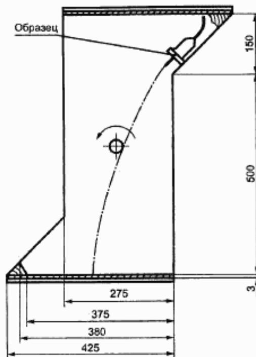
Рисунок 11 — Барабан для испытания соединителей на свободное падение
