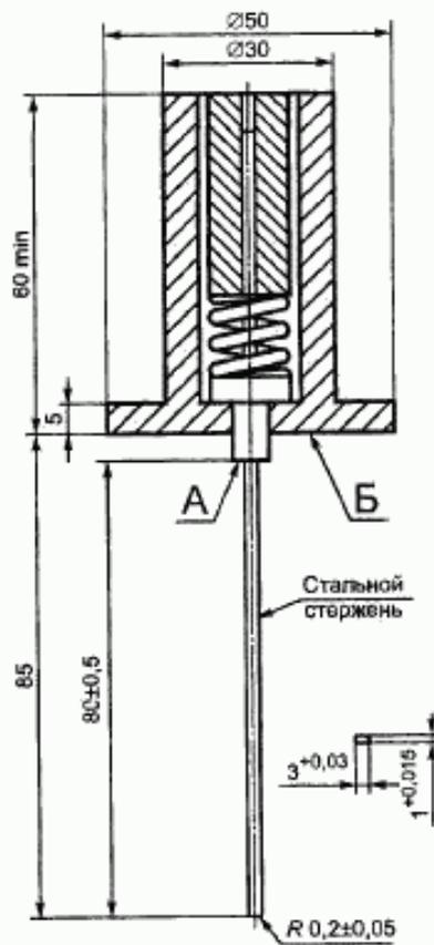
Рисунок 9 — Измерительный прибор для проверки недоступности токоведущих частей розеток через щетки после испытания на нормальную работу
