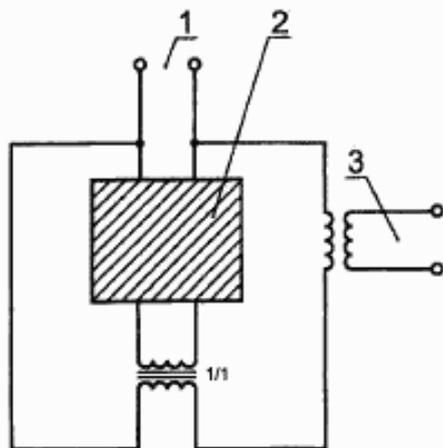
1 — источник питания при напряжении, равном  $1,1 U_{\text{н}}$ ; 2 — испытуемое УЗО-ДП; 3 — источник тока
