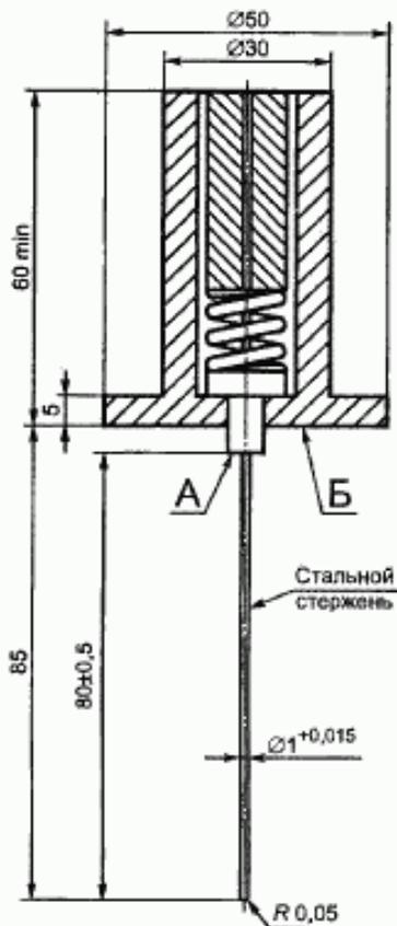
Рисунок 3 — Измерительный прибор для проверки недоступности токоведущих частей
