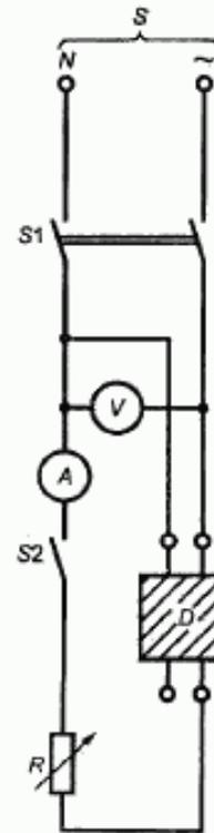
*D* — испытуемый УЗО-ДП; *S* — источник электрической энергии; *V* — вольтметр; *A* — амперметр; *S1* — двухполюсный выключатель; *S2*, *S3* или *S4* — однополюсные выключатели; *R* — регулируемый резистор
