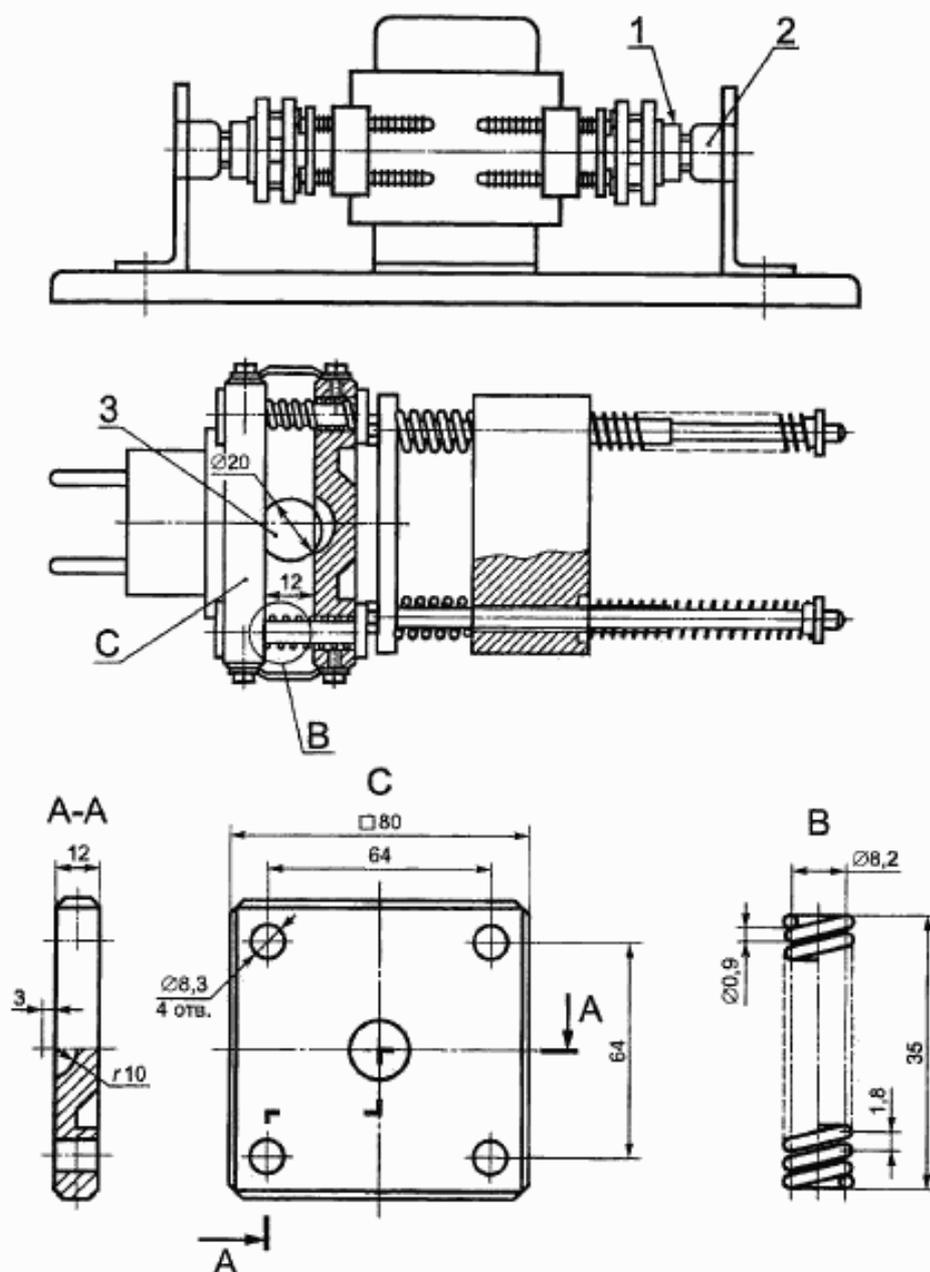
1 — вилка; 2 — розетка; 3 — стальной шар диаметром 20 мм
