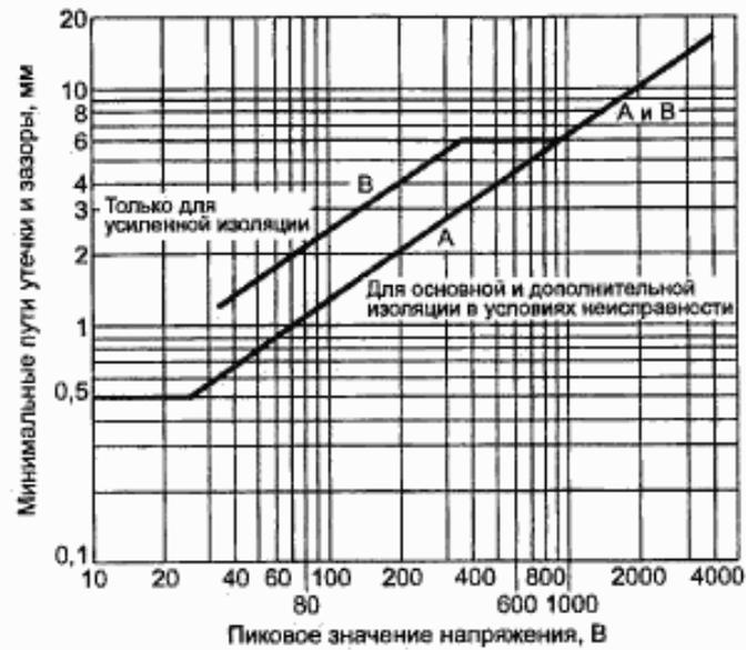
У деталей, соединенных с источником питания напряжением от 220 до 250 В (среднее квадратическое значение), выбирают те же размеры, что и для напряжения 354 В (пиковое значение):
