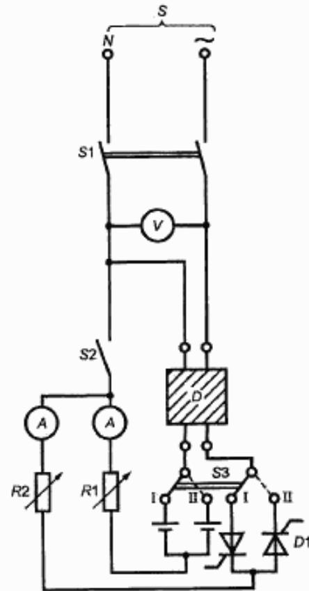
*S* — источник электрической энергии; *V* — вольтметр; *A* — амперметр, показывающий среднее квадратическое значение; *D* — УЗО-ДП; *R* — регулируемый резистор; *D1* — диод; *S1* — двухполюсный выключатель; *S2* — однополюсный выключатель; *S3* — двухполюсный выключатель на два направления
