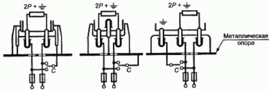
Рисунок 8 — Схемы соединения для испытания на нормальную работу
