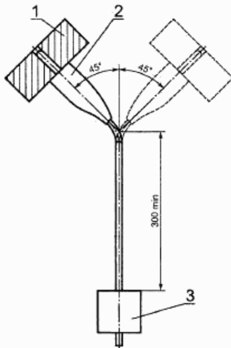
1 — устройство для закрепления образца; 2 — образец; 3 — груз
