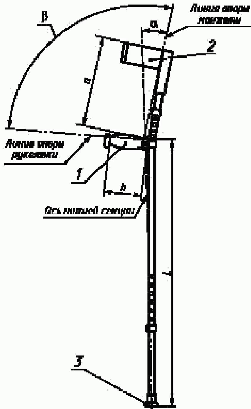
$\alpha$  — угол соединения опор;  $\beta$  — функциональный угол;  $a$  — длина верхней секции;  $L$  — длина нижней секции;  $h$  — длина рукоятки;  $f$  — рукоятка; 2 — манжета; 3 — наконечник
