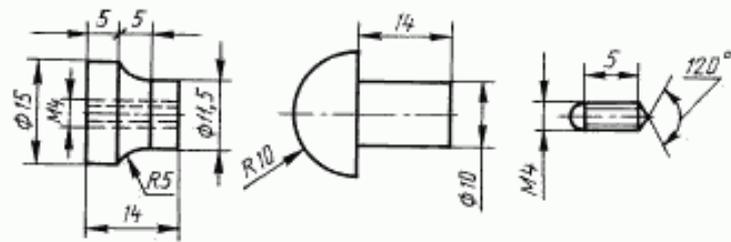
Рисунок 26 — Детали ударного элемента
