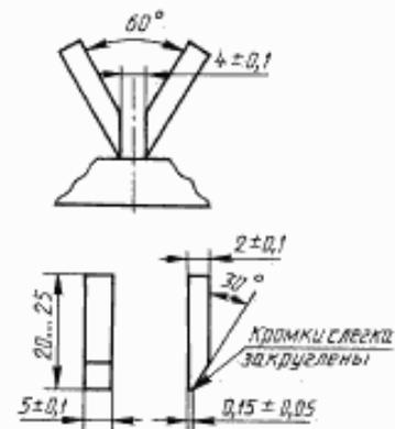
Рисунок 6 — Расположение и размеры электродов при испытании на трескостойкость
