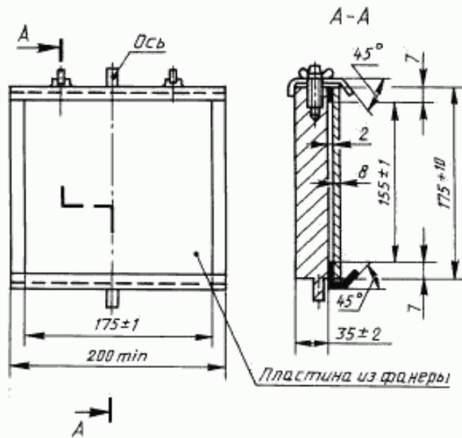
Рисунок 3 — Основание для размещения образца
