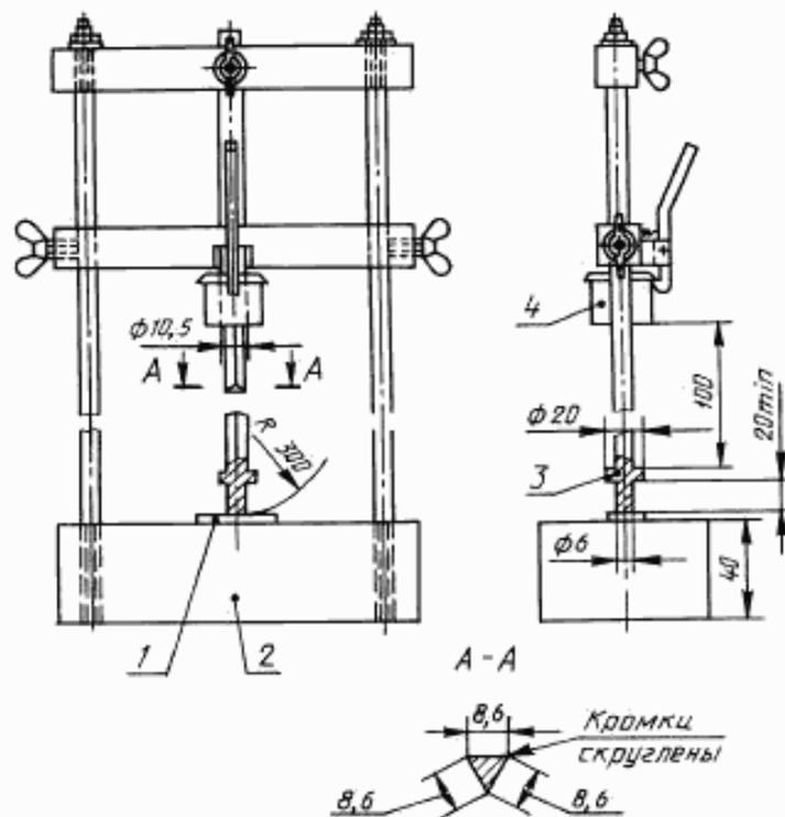
1 — образец; 2 — плита из стали массой  $(10 \pm 1)$  кг; 3 — промежуточная стальная деталь массой 100 г;
