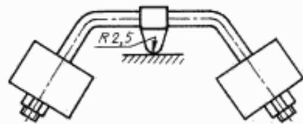
Рисунок 5 — Устройство для испытания на твердость шариком
