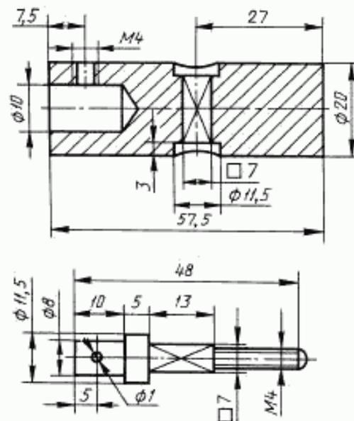
Рисунок 2а — Детали ударного элемента
