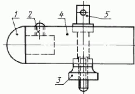
Материал детали поз. 1 — полиамид деталей поз. 2—5 — сталь
