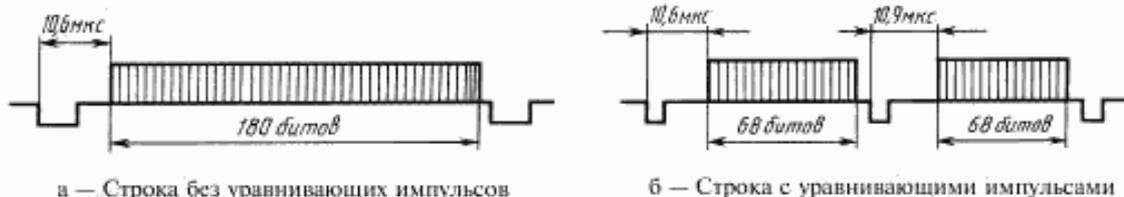
Рисунок 4 — Сигналы цифровых данных при тактовой частоте 3,468750 МГц
