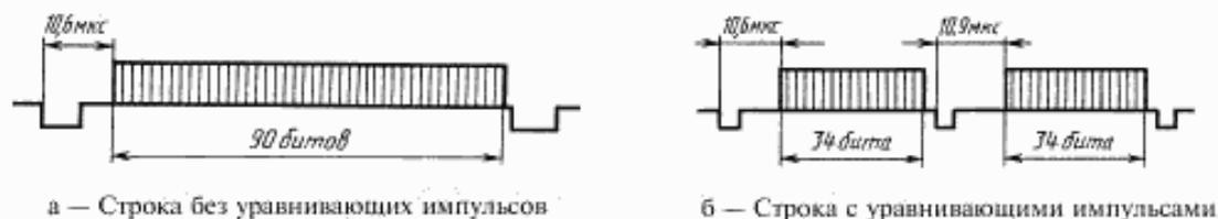
Рисунок 3 — Сигналы цифровых данных при тактовой частоте 1,734375 МГц
