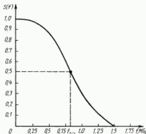
а — Спектральная плотность импульса при  $f_{T1} = 1,734375$  МГц
