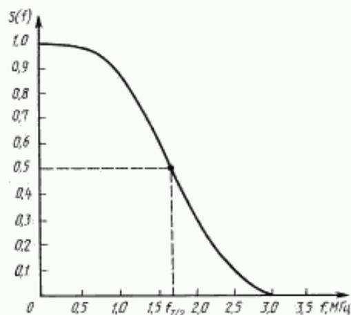
б — Спектральная плотность импульса при  $f_{T2} = 3,468750$  МГц
