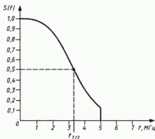
в — Спектральная плотность импульса при  $f_{T3} = 6,9375$  МГц
