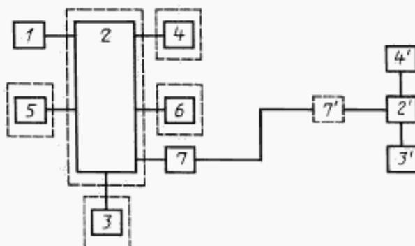
1 — извещатель; 2, 2' — установка управления; 2 — охранной (охранно-пожарный) приемно-контрольный прибор, 2' — пульт централизованного наблюдения; 3, 3' — источник электропитания; 4, 4' — световой и (или) звуковой оповещатель; 5 — устройство, управляемое установкой управления; 6 — программируемое логическое устройство; 6 — шифрующее устройство; 7, 7' — сигнальный интерфейс (модем); 7, 7' — система передачи извещений
