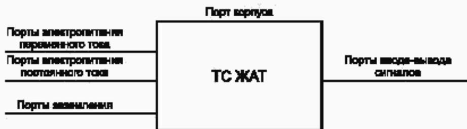
Рисунок 1 — Примеры портов ТС ЖАТ
