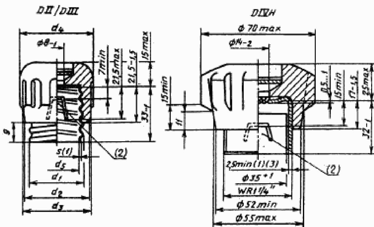
Изоляционные части выполнены из керамики, резьбовая гильза — из меди или ее сплавов.
