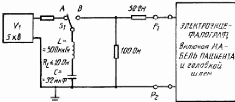
Рисунок 102 — Испытание защиты от воздействия разряда кардиодефибрилятора (см. 51.101 настоящего стандарта)
