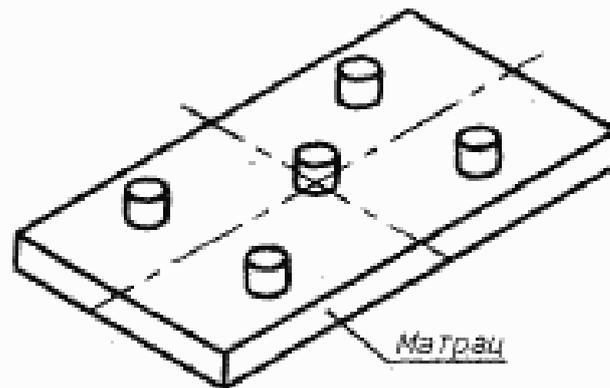
Рисунок 102 — Расположение ИСПЫТАТЕЛЬНЫХ УСТРОЙСТВ
